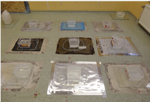
Pågående försök med nio provfält med olika spärrskikt.
